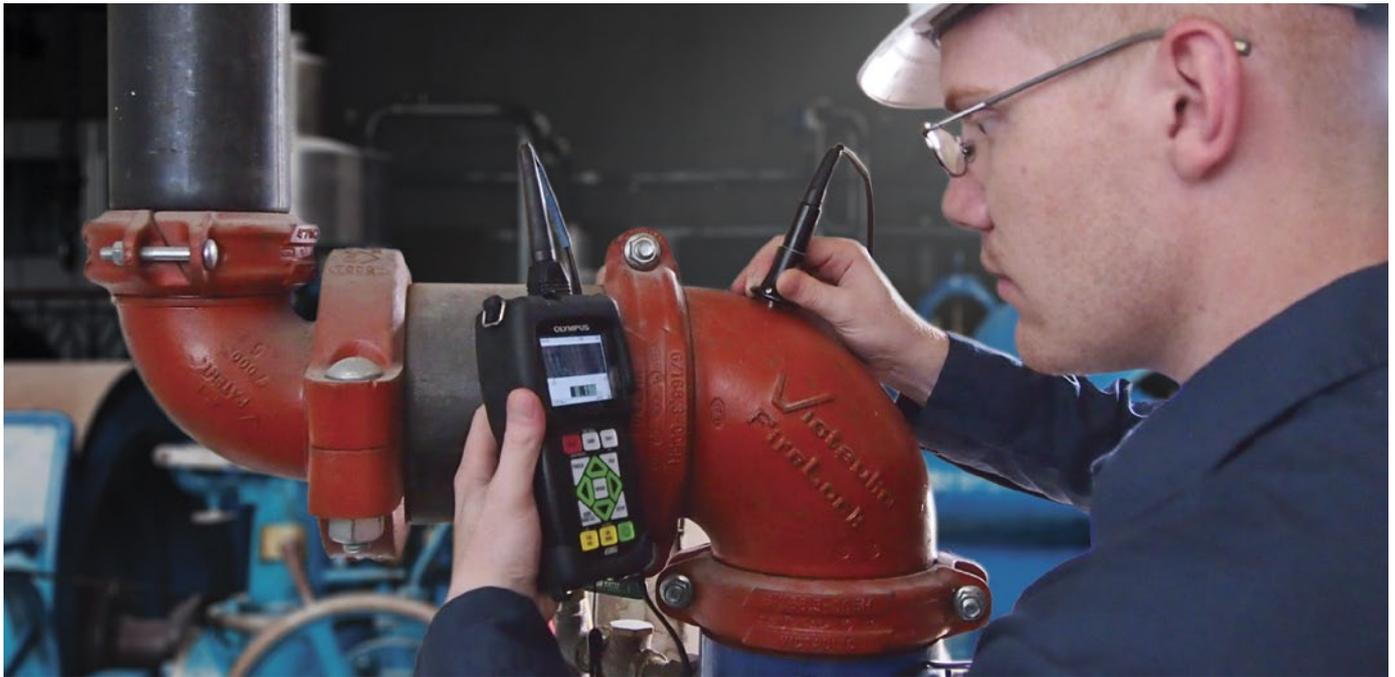
Das 45MG ist ein hochentwickelter Ultraschalldickenmesser mit Standardmessfunktionen und optionalen Softwarefunktionen. Dieses einzigartige Gerät ist mit der gesamten Palette von Olympus Einzelschwinger- und Sender-Empfänger messköpfen kompatibel, was diesen innovativen Dickenmesser zu einer Universallösung für nahezu jeden Anwendungsbereich in der Dickenmessung macht.
