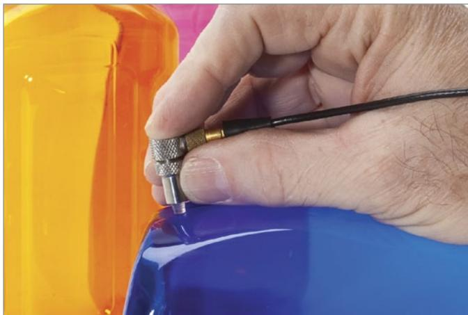
Messen von dünnem Kunststoff mit Vorlaufmesskopf mit Frequenz von 20 MHz.
